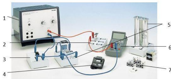
Рис. 1. Експериментальна установка: 1 – джерело струму, 2 – комутаційна коробка, 3 – перемикач, 4 – цифровий секундомір, 5 – конденсатори, 6 – цифровий мультиметр, 7 – резистори
